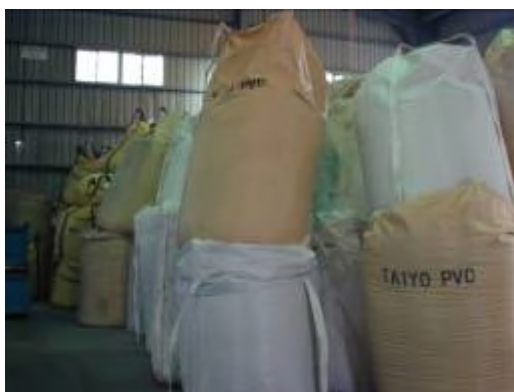
C-0110含銅集塵灰與D-2410廢玻璃纖維混合堆放
