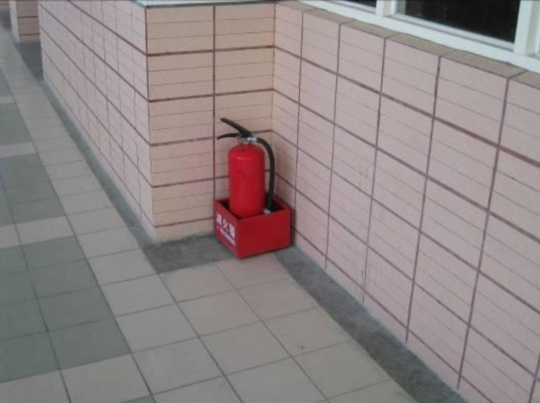
將滅火器放置於角落，雖可避免撞及，惟因走道邊緣不平整（有柱子突出），影響視障者行進，並非良好作法
