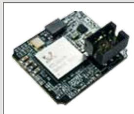
瑞昱半導體股份有限公司-整合乙太網路之車用影像暨音訊處理單晶片 (RTL9020AA)
