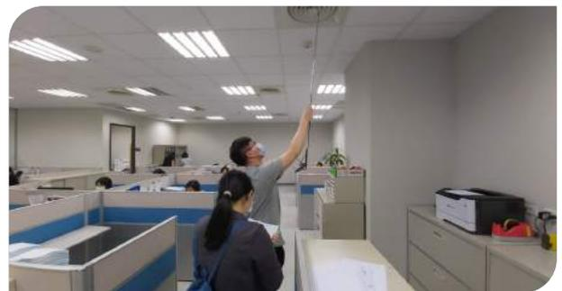
▲ 溫室氣體減量輔導作業實地勘察-出風口風速及溫度量測
