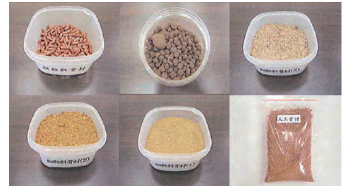
污泥經前處理後，燒結成符合相關規範之人工骨材
