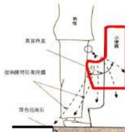
圖 3-27 抬高小便器高度改善滴尿情形
