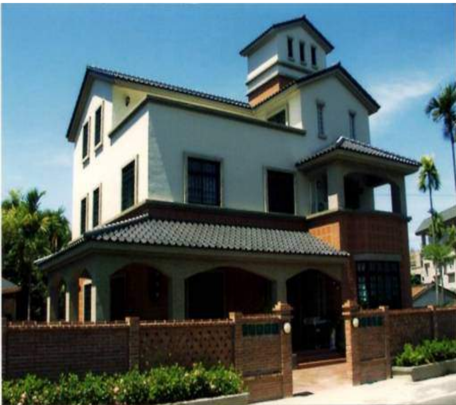
透天獨棟住宅（建築基地未達10個住宅單位者），得免設置室外通路。
