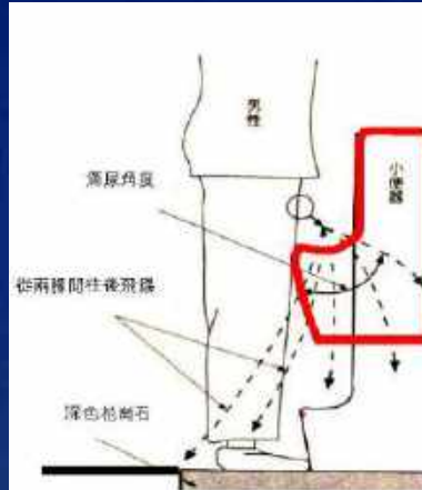
圖 3-27 抬高小便器高度改善滴尿情形
