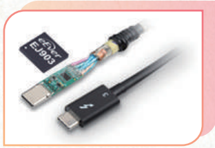
Etron Technology Co., Ltd.- E-Marker USB Type-C Cable ID Controller-EJ903
