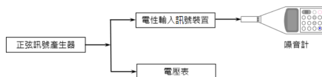
圖 9 噪音計過載指示檢測系統
