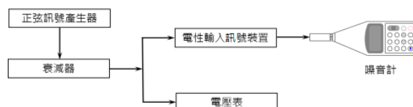
圖 7 噪音計位準線性度檢測系統
