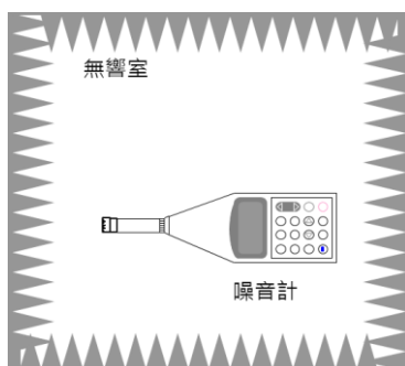
圖 2 噪音計聲訊號自雜訊測試
