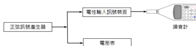
圖 11 噪音計長時間穩定性檢測系統
